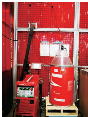
图9 大盘焊丝送丝机构及焊丝
