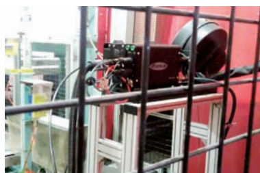
图8 小盘焊丝送丝机构及焊丝
